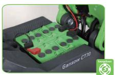
搭載AGM-EV等級深度放電免保養電池,可節省保養費用及減低耗損成本,電池材質採100%可回收物料
