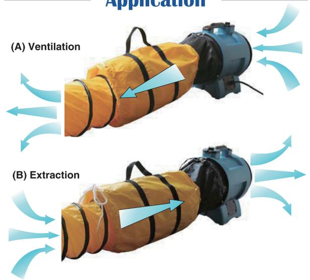
XPOWER X-8 / X-12 是一款專為密閉，狹窄空間通風設計機款，它可以通過直徑 8 英吋或 12 英吋的軟管來輸送空氣至任何狹窄，密閉的空間，如人孔和下水道等，它們可以輸送高達 125 英尺長的空氣，與所有 XPOWER 產品一樣，X-8 和 X-12 輕巧緊湊外型，攜帶方便，它們搭載低耗電量，高風量強大的密封感應式馬達，可以有效地輸送乾燥空氣以進行通風，也可放置建築物內走廊或其他較大區域，產生負壓讓空氣對流，幫助完成建築物內，快速乾燥，如體育館，健身房等
